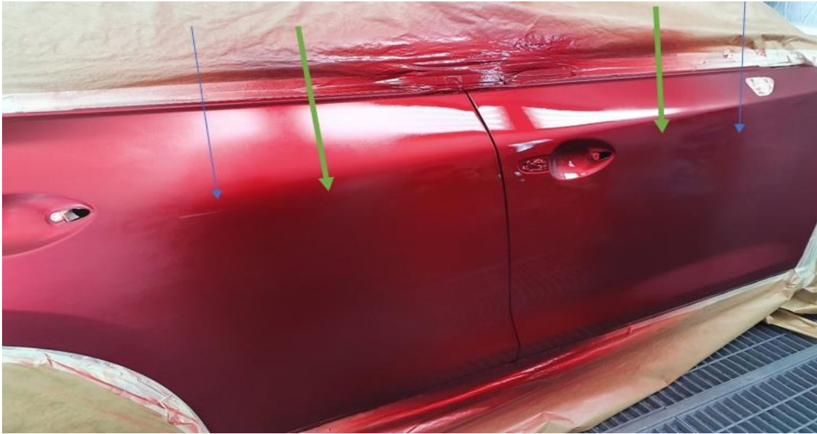
Zweite Schicht des getönten Klarlacks
