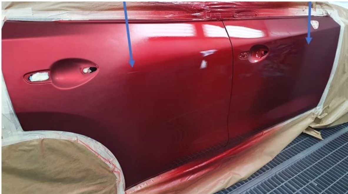
Erste Schicht des getönten Klarlacks
