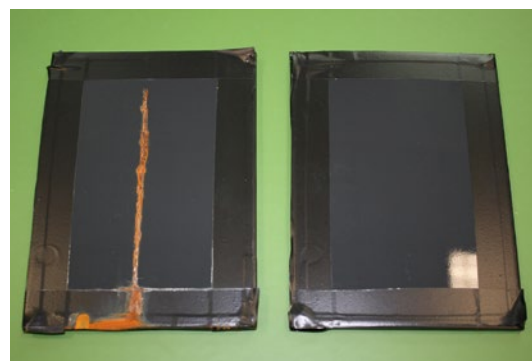
↑ Badanie w komorze solnej 720h – system NOVORUST 2290 HYBRID (grubość systemu 120 μm) podłoże blacha stalowa; sposób przygotowania: obróbka mechaniczna Sa 2 ½.
